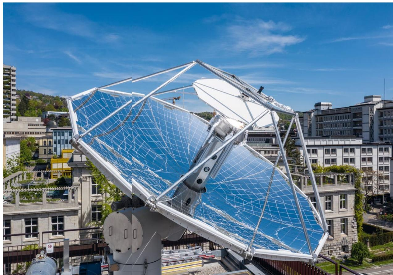
Synhelion: Diese Mini-Raffinerie-Anlage auf dem Dach der ETH produziert rund einen Deziliter Methanol pro Tag aus Luft und Sonnenlicht.
