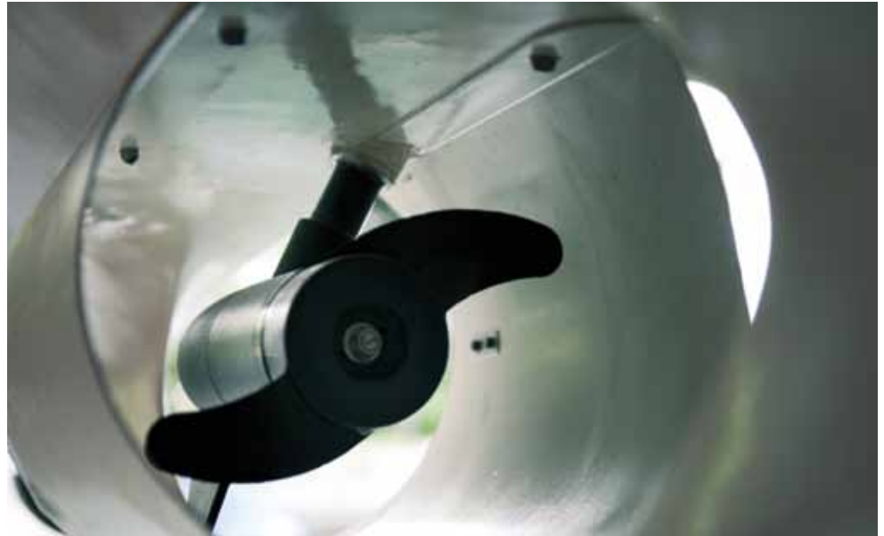
Blick auf eine der Schiffsschrauben. Nicht Schnelligkeit ist das Antriebsziel, sondern besonders ruhige und langsame Fahrt. (Bild: Roland Tännler)
